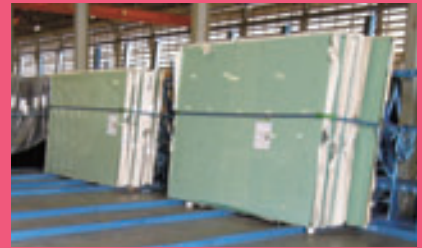
大板ガラスの立てかけ保管
