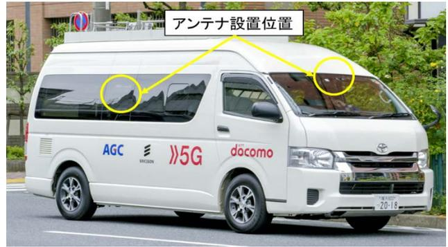
図4 5Gガラスアンテナ設置位置
