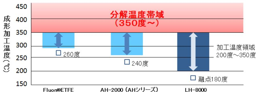
これまでは主に自動車燃料用チューブ、その他特殊用途に使用されてきた接着フッ素樹脂ですが、低融点の Fluon® LM-ETFE LH-8000 の発売により製品用途を拡大します。
