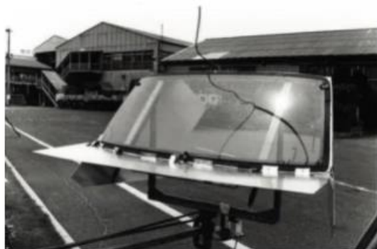
AGCによる ガラスアンテナ性能試験の様子 (1980年代)
